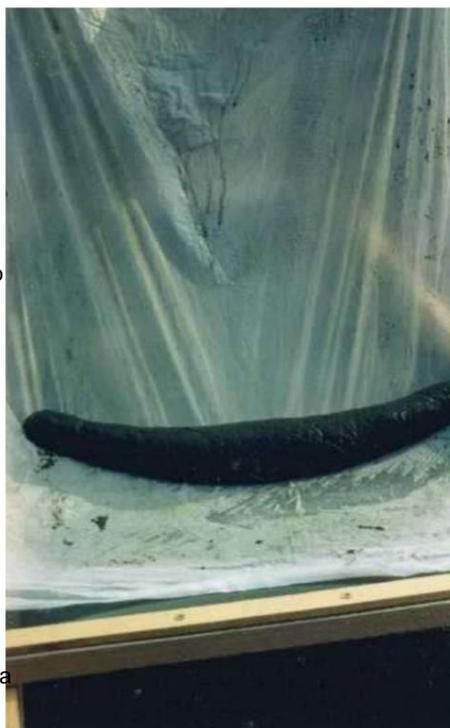
Esta operación de prensado produce una separación más eficiente del medio de cultivo residual que el lavado de la biomasa. El lavado con agua dulce puede provocar la ruptura de la pared celular de la espirulina debido al choque osmótico, lo que lleva a la pérdida de productos valiosos; también puede introducir gérmenes contenidos en el agua de lavado.
